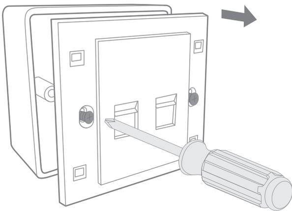
**2** 请将墙壁中的网线接上水晶头，并将其插入背面板相应接口；
